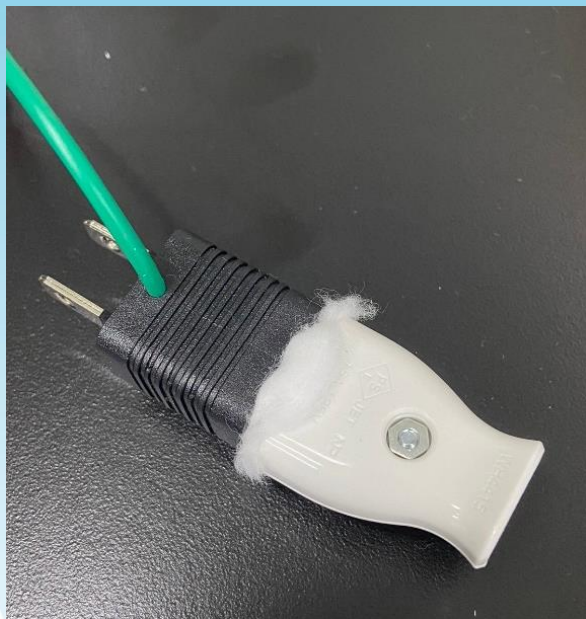
實際模擬積污插頭走火的展示設備
