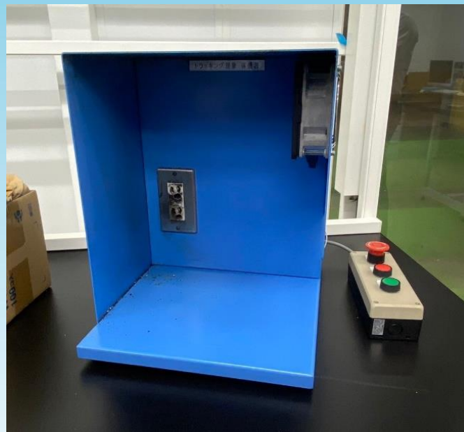
實際模擬積污插頭走火的展示設備
